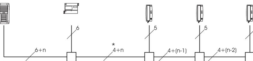
Die angegebene Adernzahl bezieht sich auf den Ruf-, Sprech- und Türöffnerbetrieb. Bei Zusatzfunktionen muß die Adernzahl entsprechend angepasst werden.
